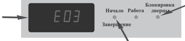
Некоторые повреждения и неполадки стиральной машины можно распознать через высвечивание кода ошибки E01 – E99.
